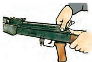
Рис. 108. Отделение крышки ствольной коробки
