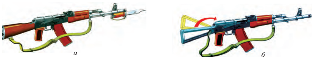
Рис. 88. Общий вид автомата Калашникова: а — АК-74 с деревянным прикладом; б — АКС-74 со складывающимся прикладом
