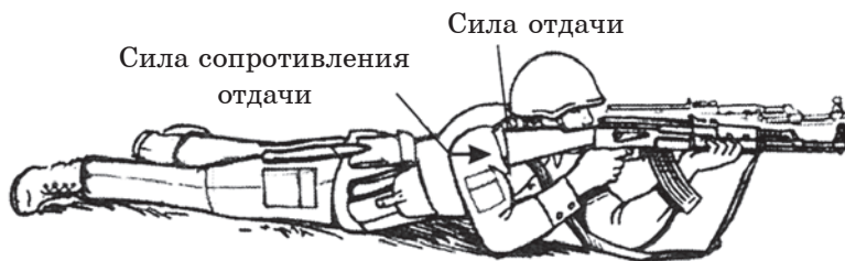
Рис. 123. Образование угла вылета
