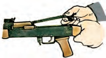
Рис. 109. Отделение возвратного механизма
