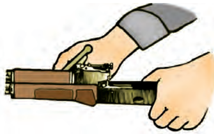
Рис. 112. Отделение газовой трубки со ствольной накладкой
