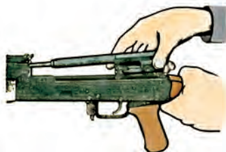
Рис. 110. Отделение затворной рамы с затвором
