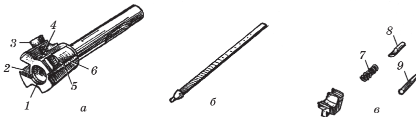
Рис. 97. Затвор: а — остов затвора; б — ударник; в — выбрасыватель.
