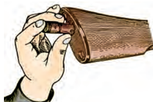
Рис. 106. Вынимание пенала принадлежностей из гнезда приклада
