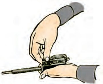
Рис. 111. Отделение затвора от затворной рамы
